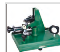
verificare l'effetto della forza laterale sull'accuratezza degli indicatori prova (è necessario un blocco semitondo)
