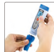
gli elettrodi possono essere sostituiti
