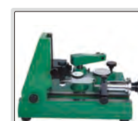
controllare l'accuratezza dei tastatori
