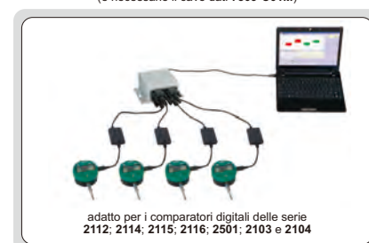
collegato con i comparatori digitali (è necessario il cavo dati 7309-C01M )
