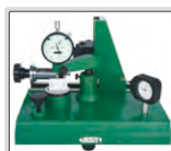
controllare la ripetibilità dei comparatori
